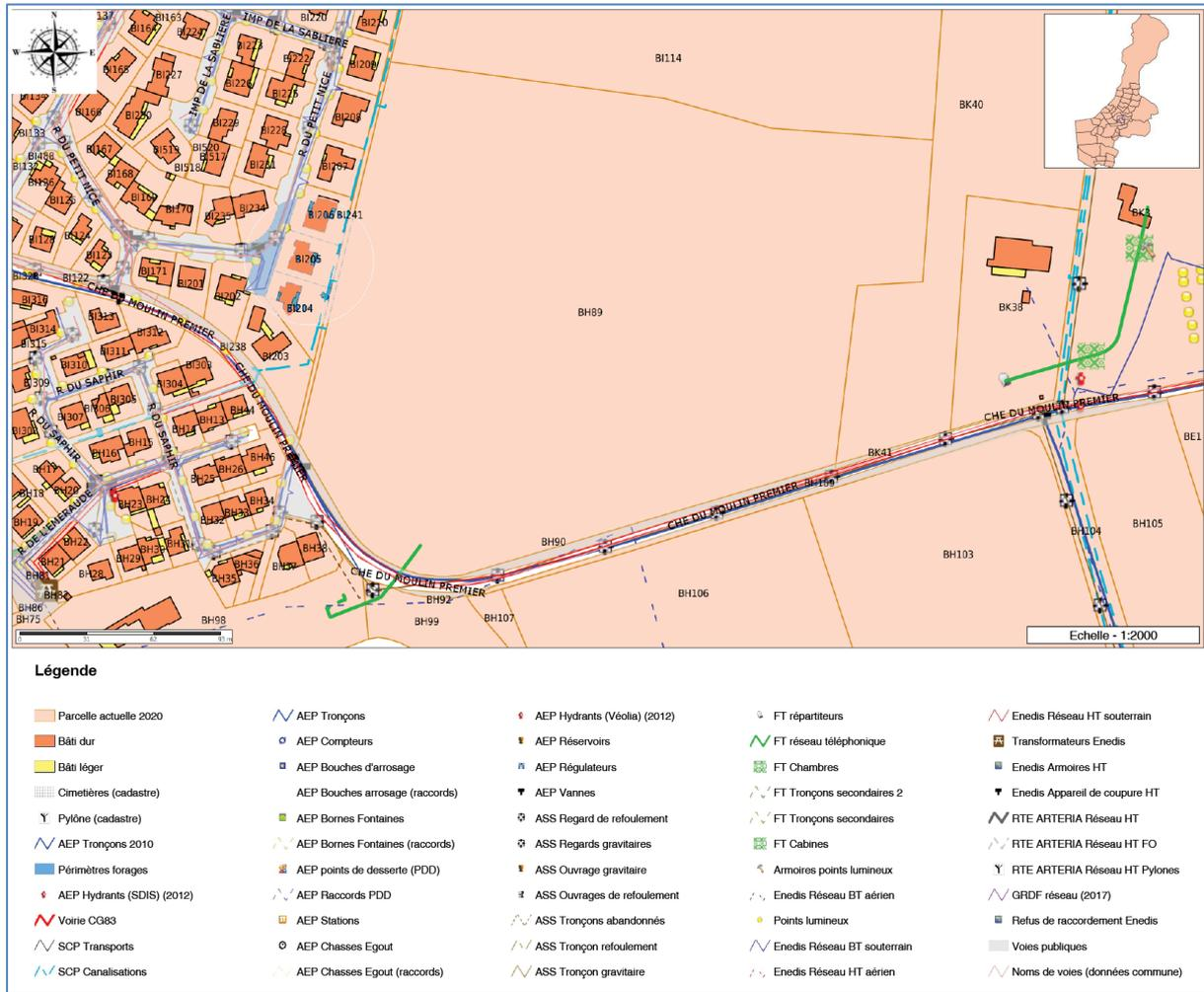
Figure 15- Les réseaux (secs et humides) existants au droit du chemin du Moulin 1er
